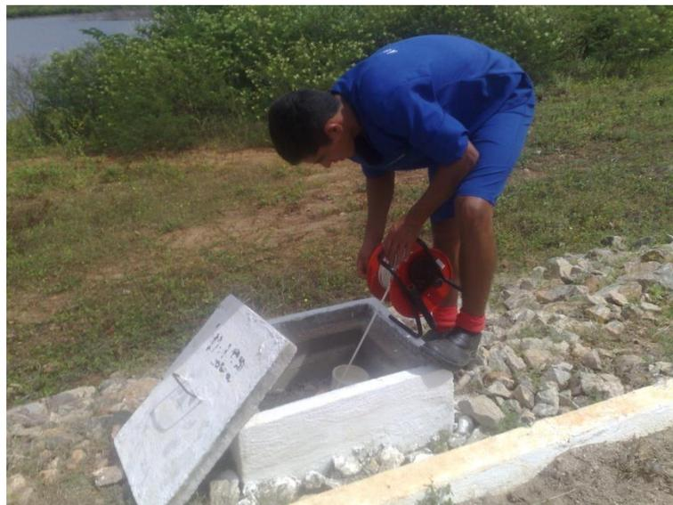
**Foto 4.1 – Procedimento de leitura do piezômetro/medidor de nível d'água**
